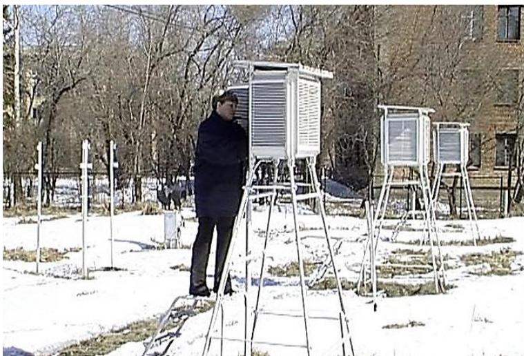
*Метеостанция. Снятие показаний приборов у поверхности земли*
