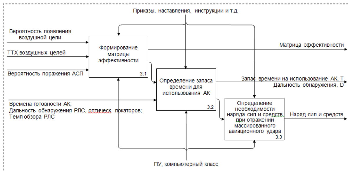
Рисунок 5. Система информационного обеспечения органа управления (штаба) в ходе проведения КШУ при отработке боевой задачи отражения авиационного удара (5 уровень)
